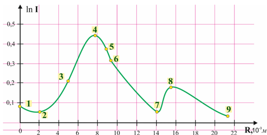
Рис. 7. Зависимость изменения интенсивности фрактальных дифракционных картин, полученных при прохождении лазерного излучения через спиралевидный транспарант при изменении осевой координаты R системы микробъектив – линза Френеля
