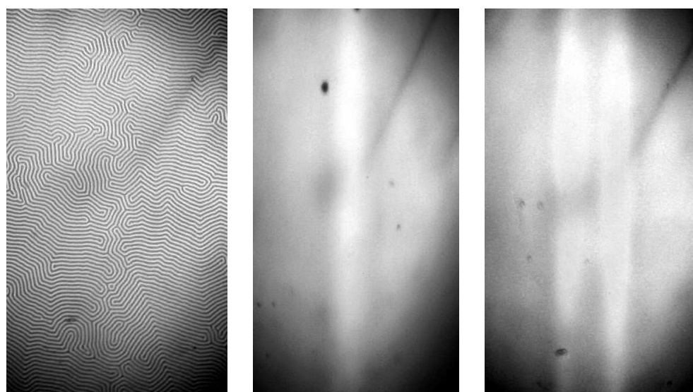
Рис. 6. Эффект последовательной смены амплитуды тока в индукторе при получении МО ВТ образа щели в нержавеющей стали. Частота тока 11 кГц.
