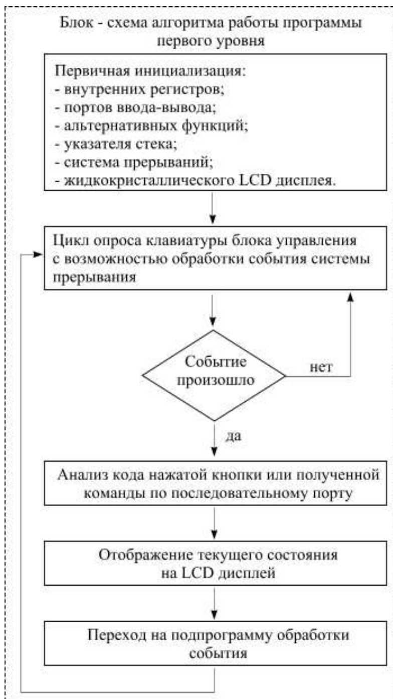
Рис. 4. Функциональная схема алгоритма работы микропроцессорного блока.
