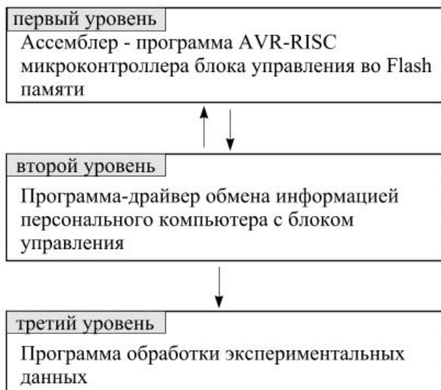
Рис. 3. Функциональная схема взаимодействия программ АСМОИ.
