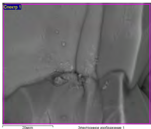
Рис. 3. Изображение пористой поверхности n -InP (111) с образовавшимися кристаллитами.
