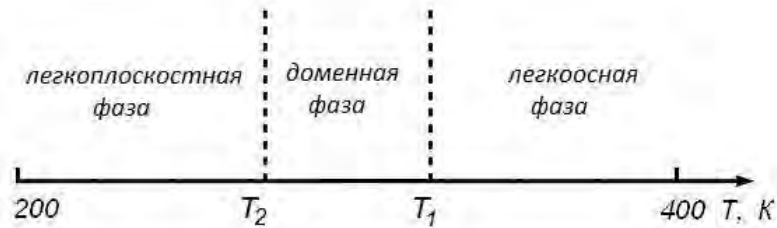
Рис. 2. Фазовая диаграмма пленки сплава U_2Co_{15}Si_2
