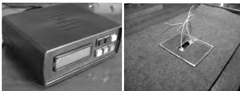
Рис. 4. Блок управления получением реплик и МО преобразователь с ЗЗП.
