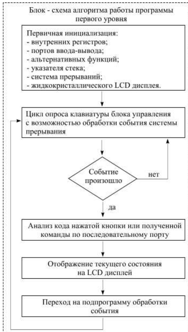
Рис. 4. Функциональная схема алгоритма работы микропроцессорного блока.
