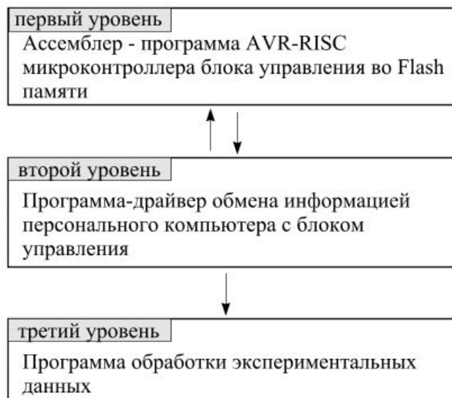
Рис. 3. Функциональная схема взаимодействия программ АСМОИ.
