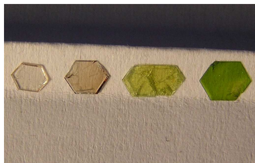
Рис. 4. Монокристаллы \text{Fe}_x\text{Ga}_{1-x}\text{VO}_3 с различными значениями x .
