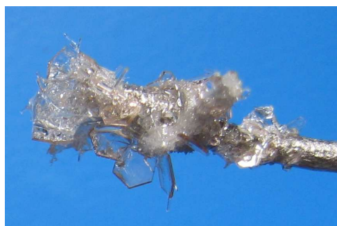
Рис. 3. Монокристаллы \text{Fe}_x\text{Ga}_{1-x}\text{VO}_3 на затравкодержателе.
